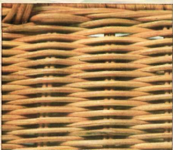
Каждый основной прут сделан из двух тонких прутьев вдоль. После плетения бока смазывают оливковым маслом для придания прутьям яркости.
