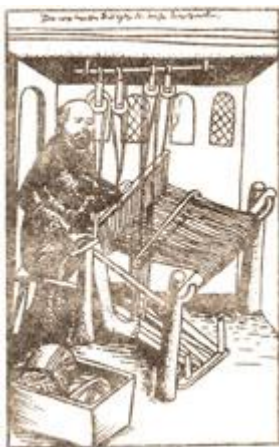
Рис. 8 Немецкий ткацкий станок XIV века
